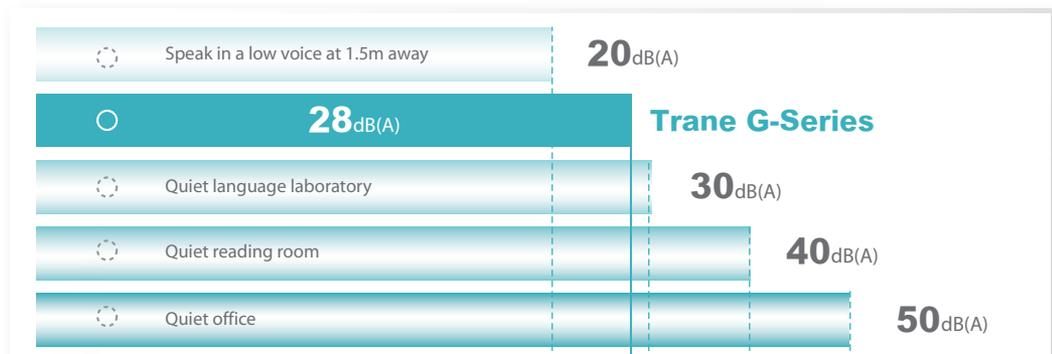
\*Nivel de ruido interior de los sistemas de 9 MBH medido a baja velocidad.
